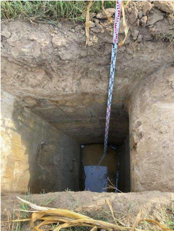
**Bild 3: BS 3 zur Profilaufnahme mit angetroffenem Grundwasser**
