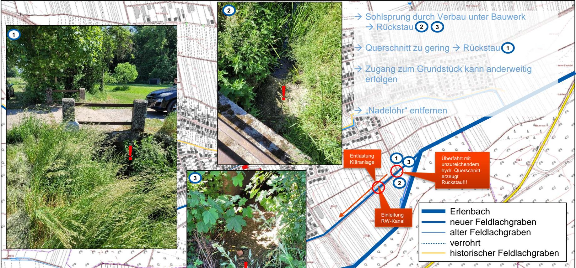
Zur Optimierung der innerörtlichen Situation ist es unabdingbar, dass die Regenentlastung in den Erlenbach ohne Rückstau funktioniert.
